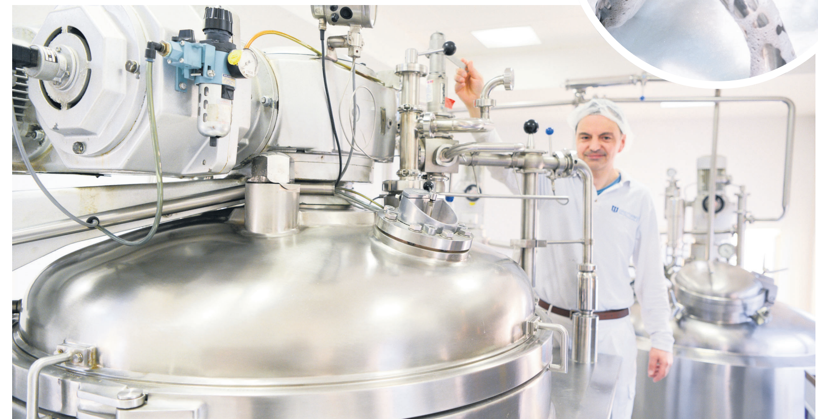
Da wird Sonnenspray draus: Chemikant Dirk Talome bei der Arbeit. Das kleine runde Bild rechts oben zeigt den überdimensionalen Rührstab im Inneren der Vakuumanlage.
